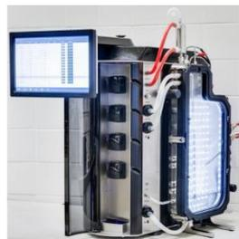
Biostream BioBench Lux 平板 LED 光照反应器
